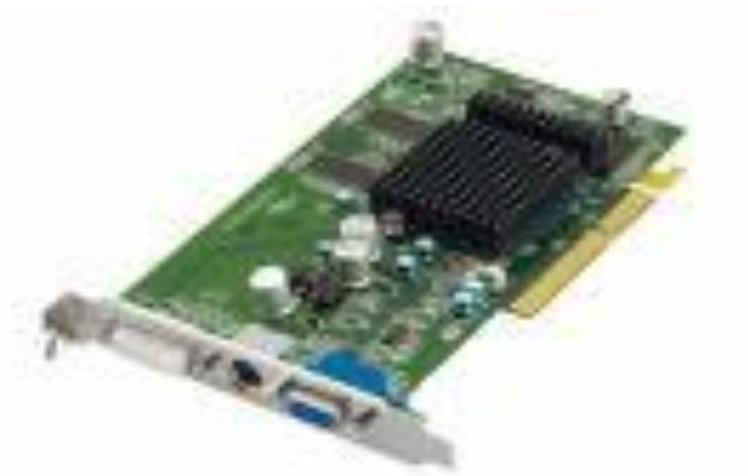
รูปที่ 1.7 แสดงอุปกรณ์การ์ดแสดงผล (Graphic Card)
